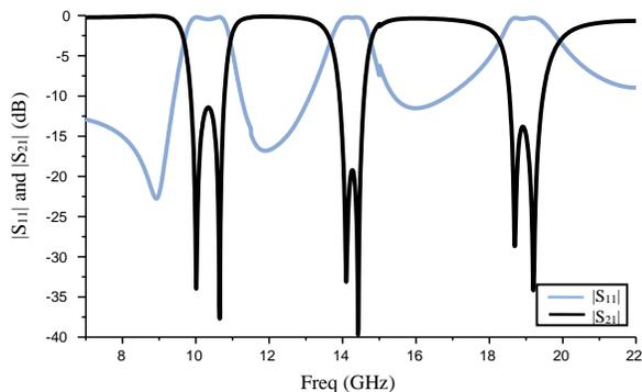
Fig. 3. Simulated transmission and reflection coefficients of a tri-band FSS ( $b=6\text{mm}$ ,  $h=3.524\text{mm}$ ,  $L=9.5\text{mm}$ ,  $d=1.524$ ,  $w=0.3\text{mm}$ ,  $L_1=9.5\text{mm}$ ,  $L_2=6.5\text{mm}$ ,  $L_3=4.75\text{mm}$ ).
