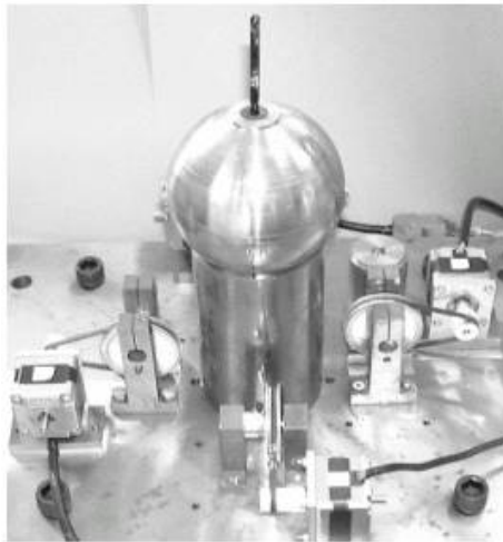
図1. 試作したワイヤーけん引式球面モータ
